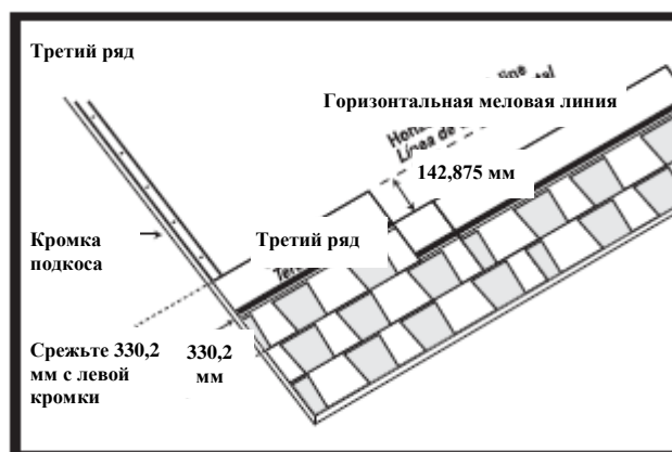
Рис. 5С Нанесение кровельных плиток
