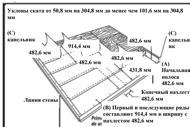
Рис. 3А Низкий уклон ската для подстилающего слоя
