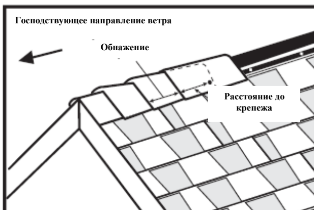
Рис. 8 Нанесение на ребра и коньки
